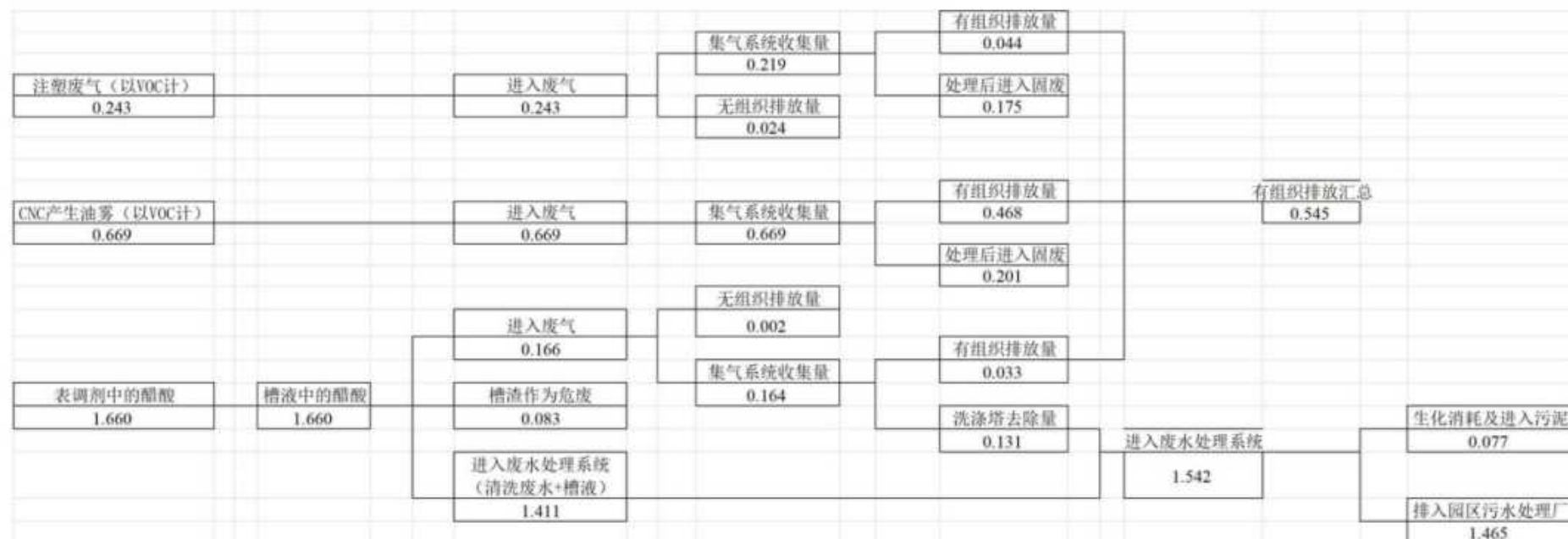
图 3.2-14 项目 VOC 平衡图 (单位: t/a)
