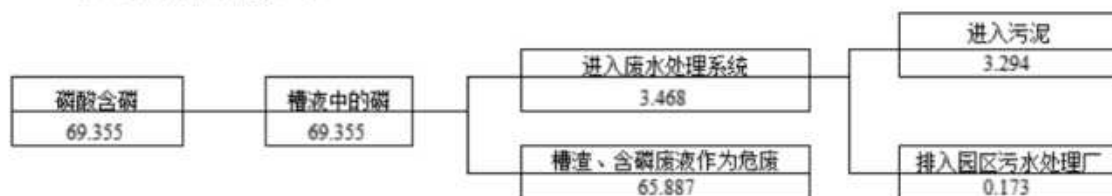
图 3.2-12 项目磷平衡图 (单位: t/a)
