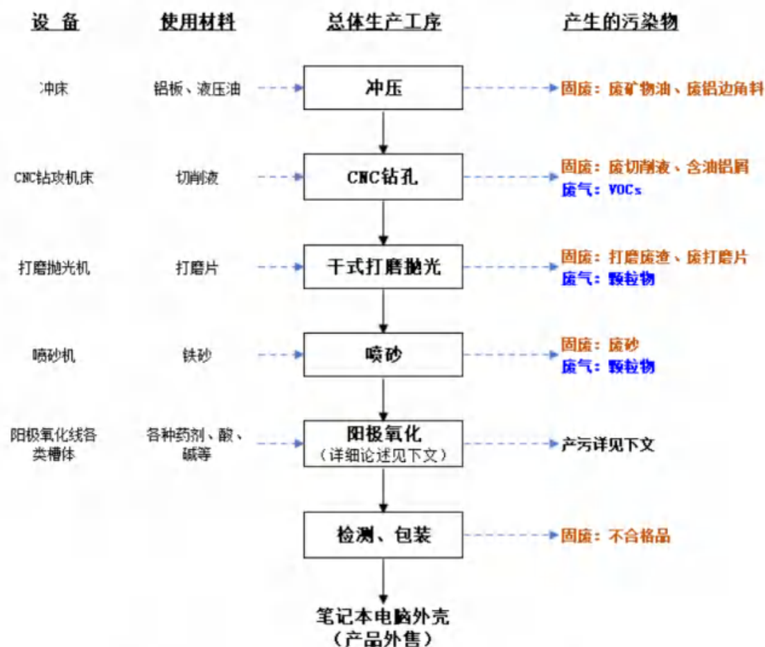
图 3.2-1 本项目笔记本电脑外壳生产工艺流程图
