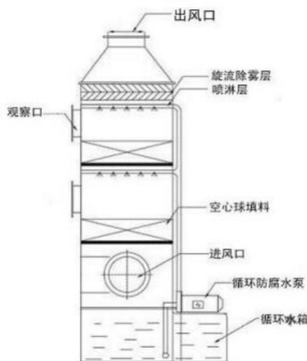
典型水洗塔结构示意图
