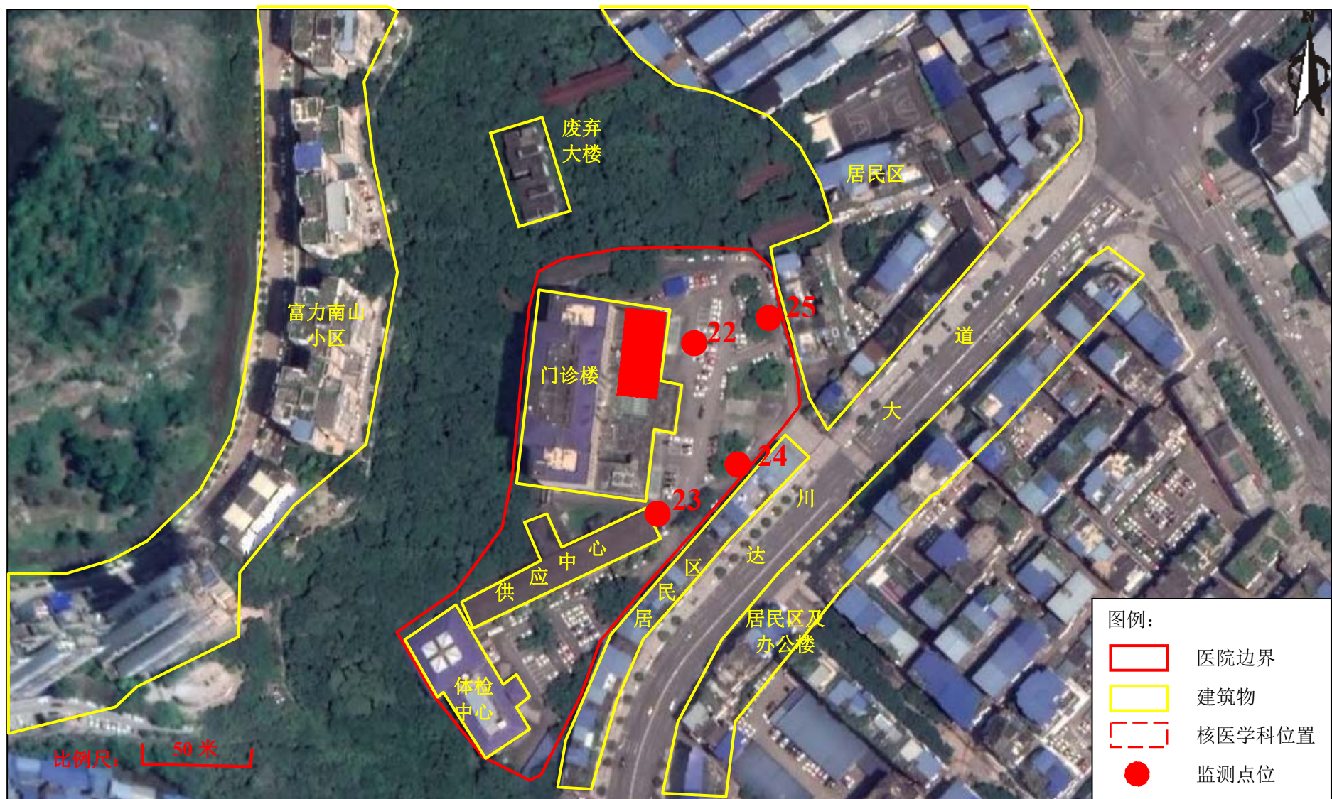
图 8-2 本项目核医学科所在楼周围辐射质量现状监测点位图
