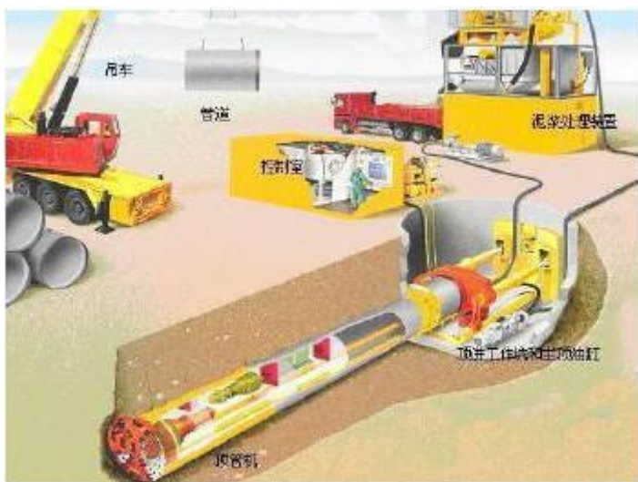
图4.1.1-6 顶管施工工艺简图及立面图
