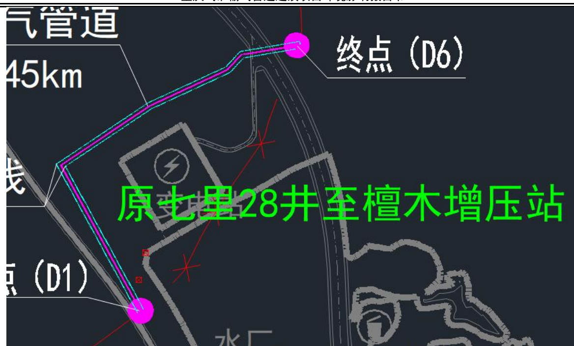
图 1-2 规划水厂现有集气管线分布图（红线表示）
