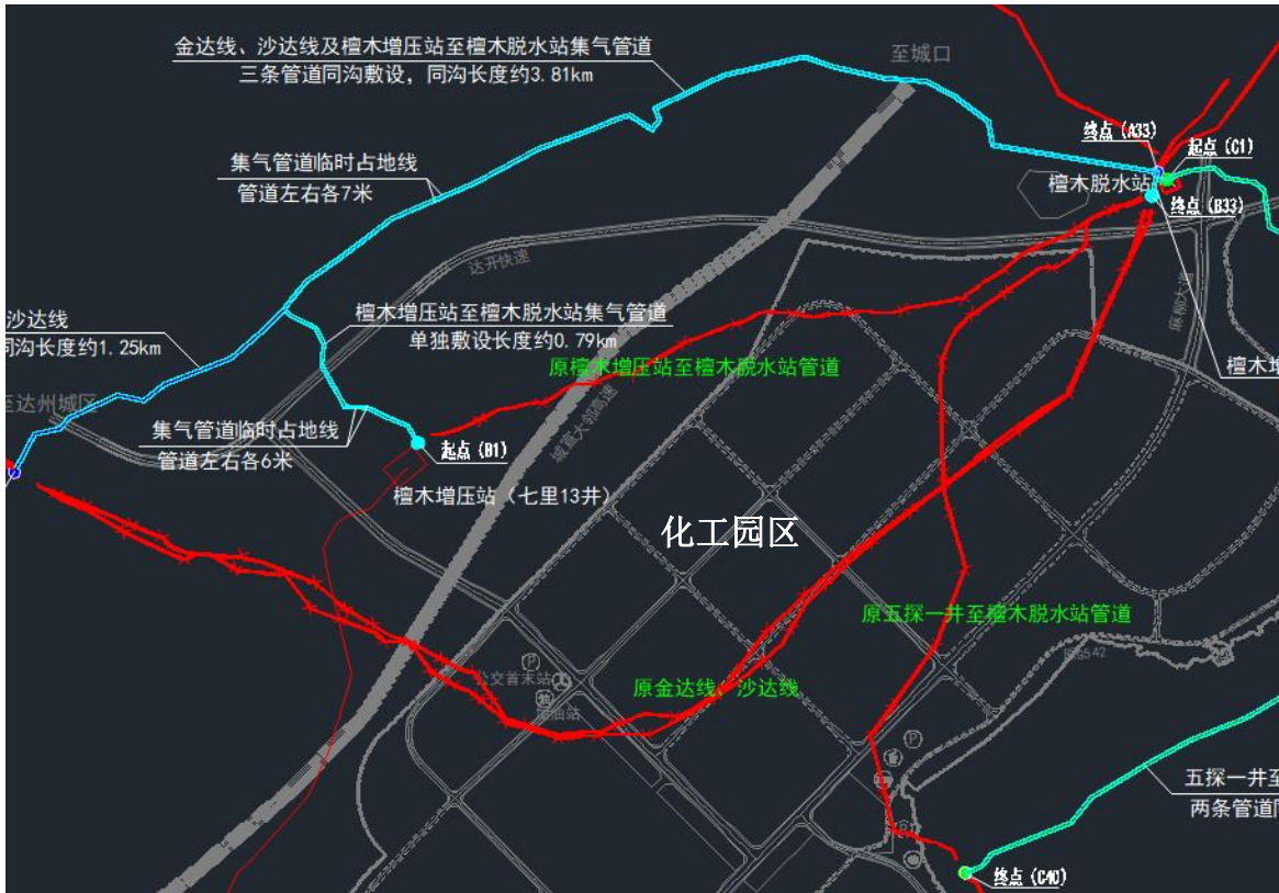
图 2-2 规划化工园区内现有集气管线分布图（红线表示）
