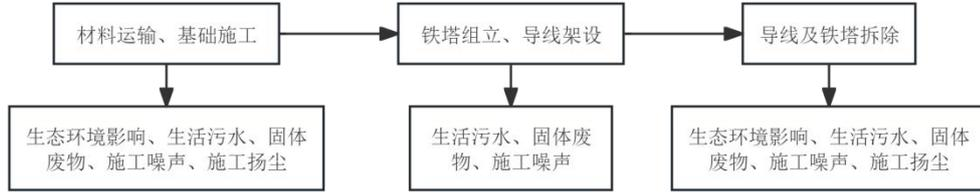
**图4-1 施工期工艺流程及产物环节图**
