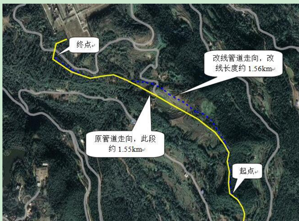
图 3.2-1 黄家坝村段（A 段）改迁管线走向图
