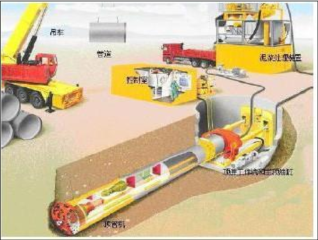
图 2.3-3 顶管施工工艺简图及立面图
