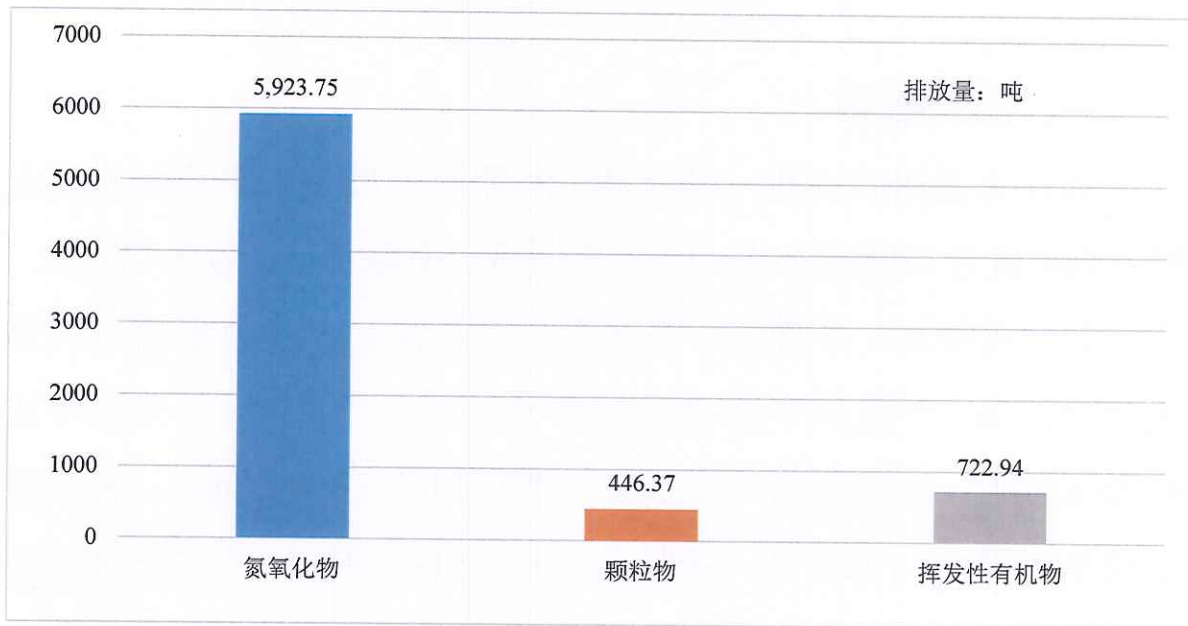
图 6.3-1 达州市 2017 年非道路移动污染源主要大气污染物排放量
