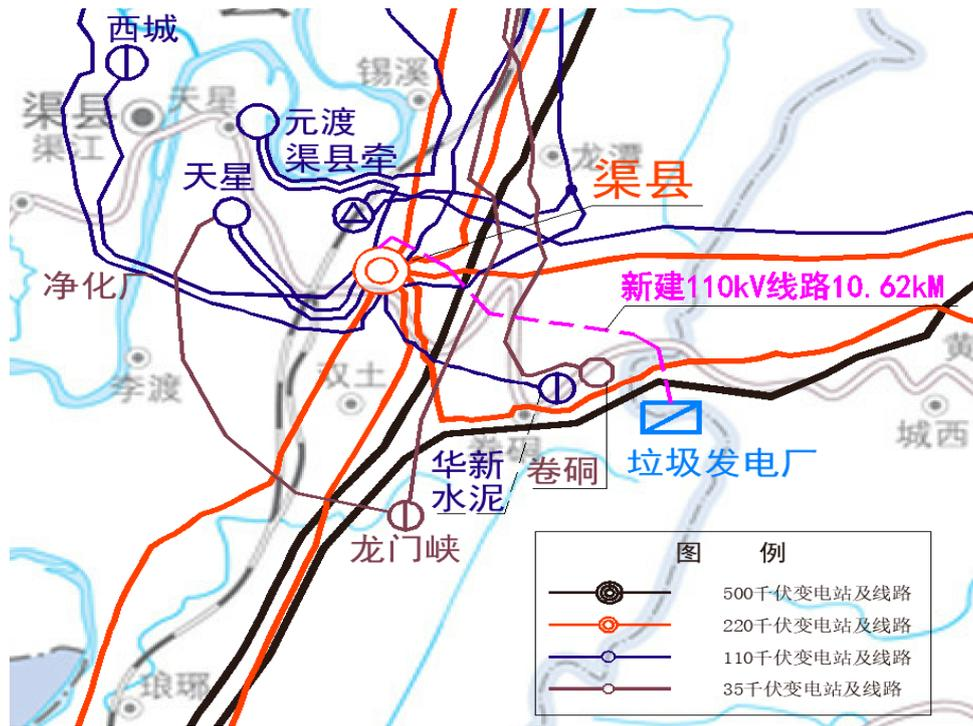
注：图中紫色虚线为本次拟建输电线路
